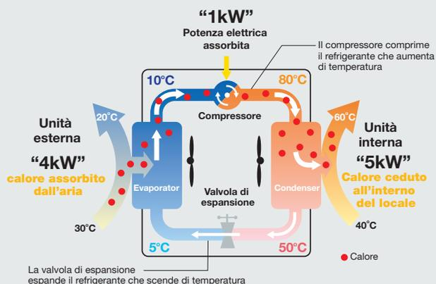
La potenza termica fornita all'interno del locale è il quintuplo della potenza assorbita dalla rete elettrica
