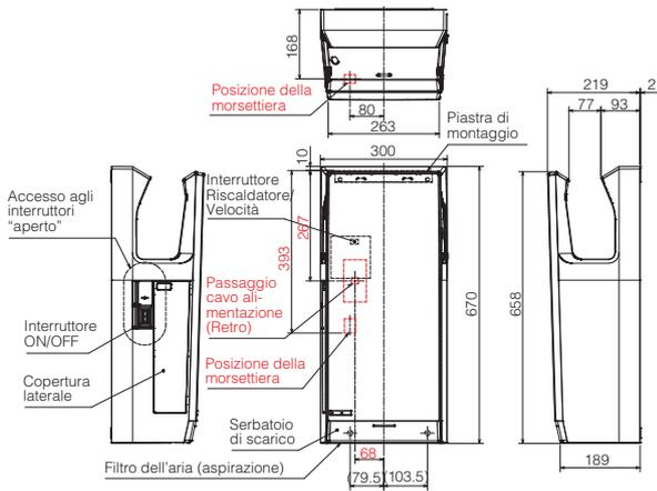
\*I caratteri in rosso indicano le dimensioni per il cablaggio in loco
