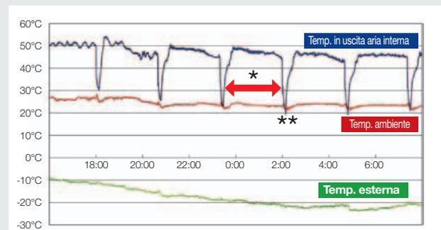
\* Con il Controllo Sbrinamento di ZUBADAN, l'intervallo massimo tra due operazioni di sbrinamento è stato di 150 minuti con temperature esterne di circa -20°C o 0°C.
