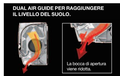
**IN RISCALDAMENTO** i 2 deflettori vengono orientati in modo convergente, in modo da aumentare la velocità dell'aria affinché raggiunga facilmente il suolo.
